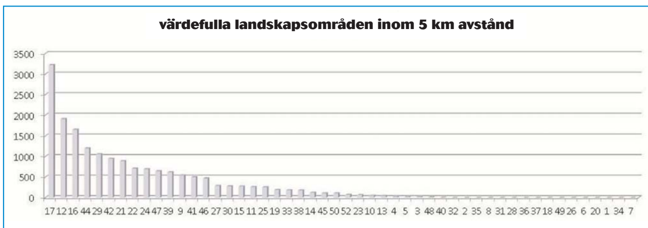
Figur 10 och 11. Exempel på skillnaderna mellan olika områden beträffande olika faktorer. Det övre diagrammet visar antalet fritidshus och bostäder som finns inom mindre än 5 km avstånd och från vilka kraftverken syns. Det nedre diagrammet visar arealen av de värdefulla landskapsområden som ligger på mindre än 5 km avstånd och från vilka kraftverken syns. Vindkraftsområdenas nummer på horisontalaxeln (se tabell 8).
